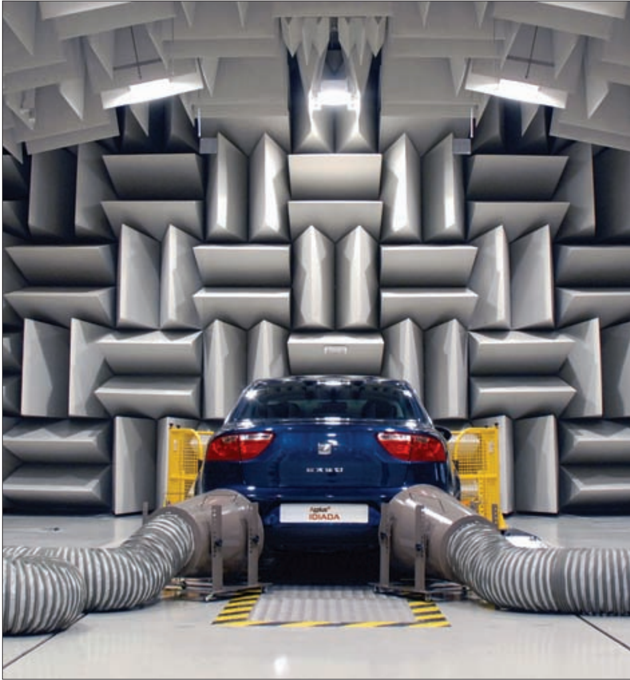
Un vehicle passa unes proves a la cambra semianecoica de l'Institut d'Investigació Aplicada de l'Automòbil.
