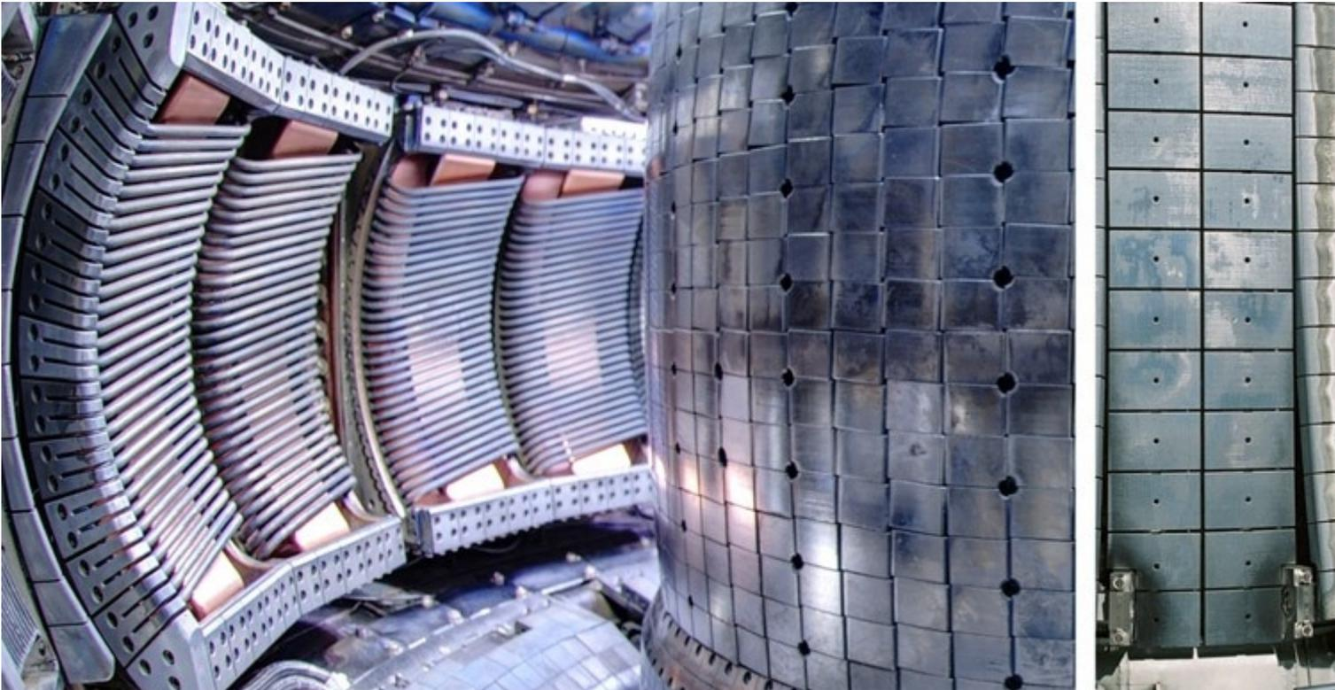
Visión interior del Alcator C-mod (izquierda) y de JET (derecha), los reactores tipo *tokamak* donde los experimentos reportados en el artículo de *Nature Physics* fueron llevados a cabo. Fuente: Plasma Science and Fusion Center, Massachusetts Institute of Technology y EUROfusion.
